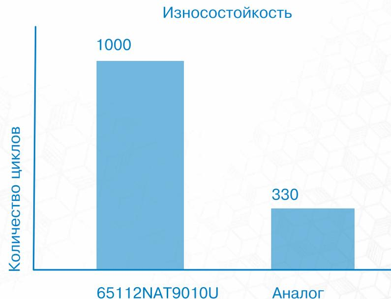
Исходя из графика, через 1000 циклов образец из ТЭП MASFLEX потеряет вес на 10%, в то время как образец из аналогичного материала потеряет этот же вес уже на 330-м цикле. Таким образом, показатель износостойкости у ТЭП MASFLEX по сравнению с аналогами выше почти в 3 раза.
